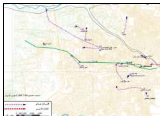
شکل ۲- موقعیت خط ۲ متروی تبریز به همراه قنات‌های موجود در مسیر تونل (س. ق. ش. تبریز)
