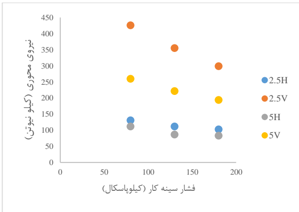
شکل ۱۱- تأثیر فشار سینه‌کار بر روی نیروی محوری سیستم نگهداری قنات در چهار حالت مورد بررسی
