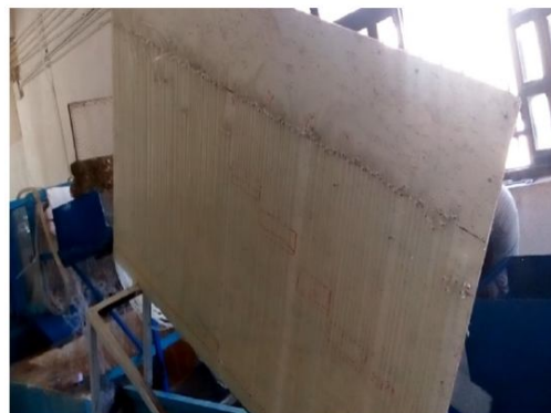
شکل ۲- تابلو نصب پیزومترها با چرخش ۳۰ درجه
