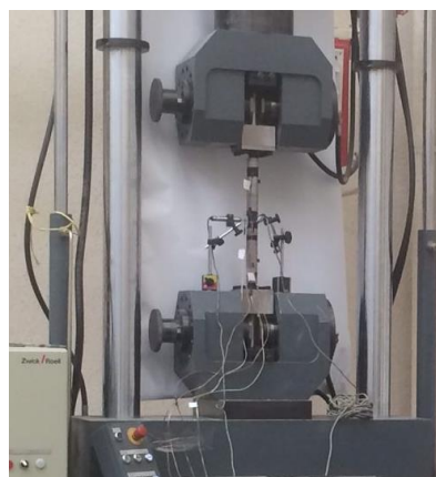
شکل ۶- نمونه آزمایشگاهی ابزار محدودگر نیروی آکاردئونی داخل جک هیدرولیکی
