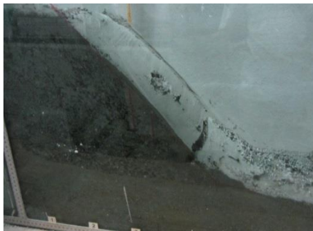
شکل ۲۸- ترک ایجاد شده در پنجه شیب مسلح با شمع به قطر ۳/۶ و طول ۱۶ سانتی‌متر
