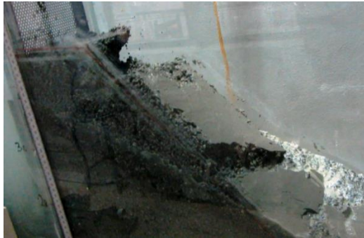
شکل ۲۷- گسیختگی شیب خاکی همگن غیر مسلح
