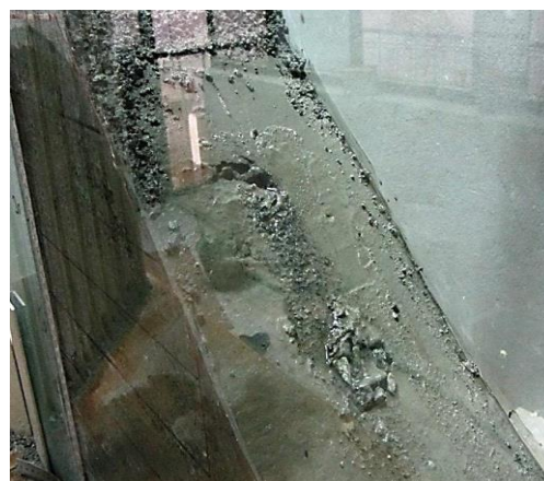
شکل ۲۹- ترک ایجاد شده در شیب خاکی همگن
