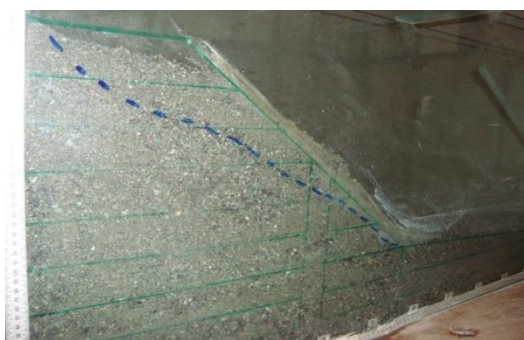
شکل ۳۰- سطح لغزش در شیب با حضور شمع
