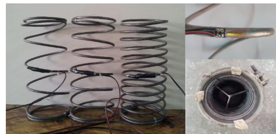
شکل ۲- نمونه نصب کرنش‌سنج بر روی دور پیچ، گام دور
