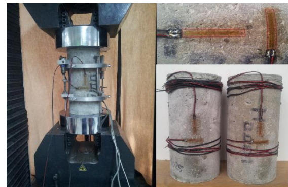
شکل ۱- نمونه نصب کرنش‌سنج بر روی آزمون‌ها و آزمایش آن
