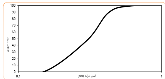
شکل ۹- نمودار دانه‌بندی خاک مورد استفاده
