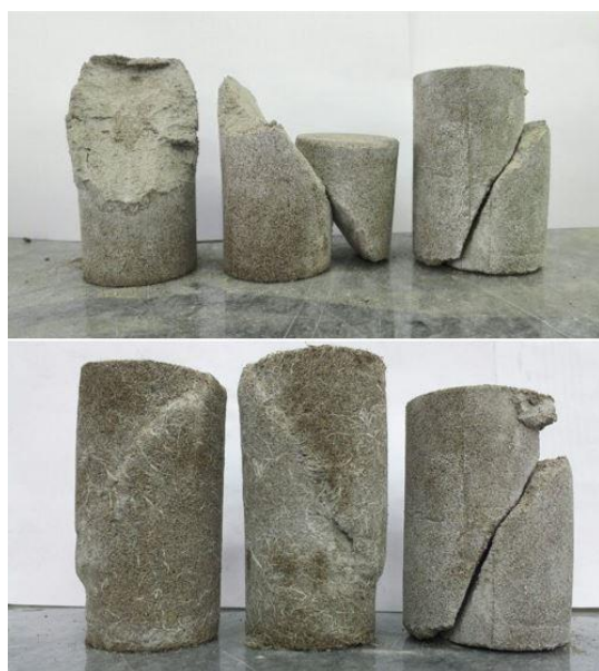
شکل ۲- مد گسیختگی نمونه های تحت آزمایش
