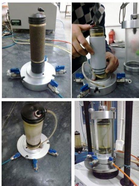
شکل ۱- مراحل جای گذاری نمونه روی پایه دستگاه
