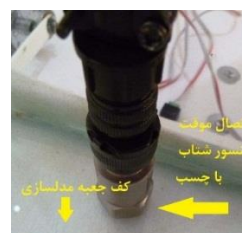
شکل ۷- نصب سنسور شتاب سنج پیزوالکتریک تک محوری با حساسیت بالای 1000mv/g در کف جعبه مدل‌سازی میز لرزه (با محدوده فرکانسی ۰/۱۰ تا ۱۰ کیلوهرتز)
