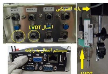
شکل ۸- سیستم جمع‌آوری اطلاعات تغییر شکل شیب در مدل فیزیکی شامل LVDT، جعبه اتصال دیتالاگر و مدار رابط رایانه
