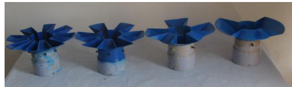
شکل ۲- مدل سرریز تاج دندانهای با ارتفاع نسبی P/D معادل 0.5/1 (شیب کلید 0.5/1 ) در سیکل های مختلف
