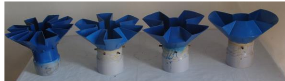
شکل ۳- مدل سرریز تاج دندانهای با ارتفاع نسبی P/D معادل ۱ (شیب کلید 1/1 ) در سیکل های مختلف
