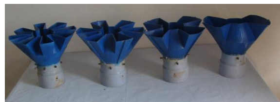
شکل ۴- مدل سرریز تاج دندانهای با ارتفاع نسبی P/D معادل 1/5 (شیب کلید 1/5 ) در سیکل های مختلف
