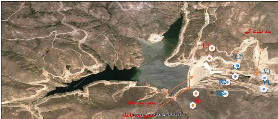
شکل ۲- تصویر گوگل از سد باطله، گمانه‌های موجود (L1 و R1) و گمانه‌های حفاری شده (L2 و R2 و V1)
