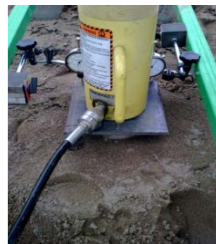
شکل ۳- گیج‌های اندازه‌گیری جابه‌جایی شمع
