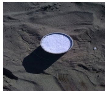
شکل ۱- گذاشتن یونولیت در غلاف
