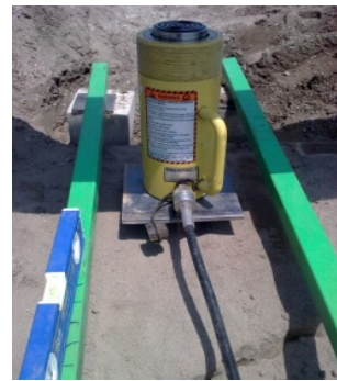
شکل ۲- جک هیدرولیکی مورد استفاده
