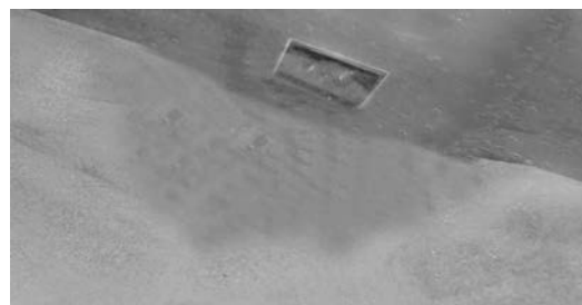
شکل ۵- حفره آبشستگی نهایی
