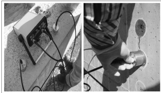
شکل ۴- دستگاه اولتراسونیک و نحوه انجام آزمایش در محل
