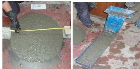
شکل ۱- آزمایش جعبه L شکل و جریان اسلامپ
