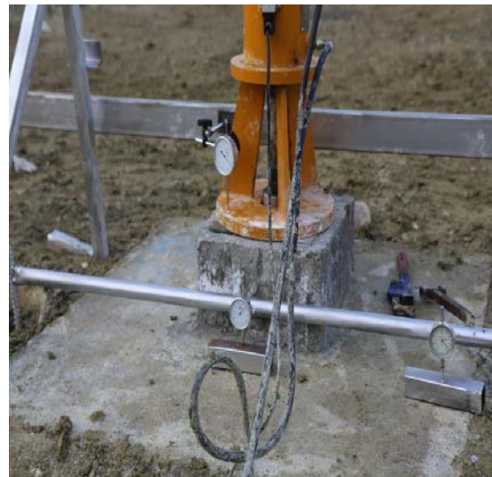
شکل ۲- تصویر تجهیزات جانبی جک کشش میخ و نحوه اتصال آن به میخ
