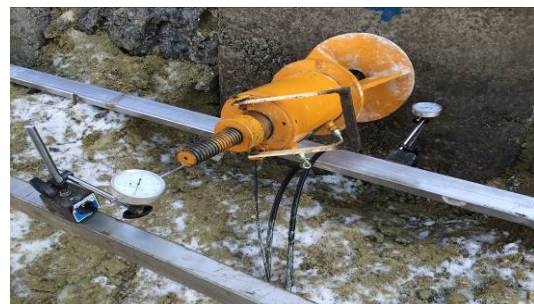
شکل ۸- نمونه‌برداری از گروت سیمانی جهت تعیین مقاومت فشاری قبل از انجام آزمون کشش میخ
