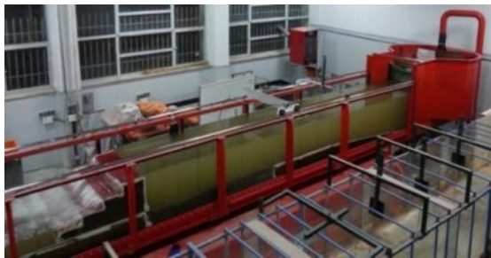
شکل ۳ - چیدمان آزمایشگاهی و نحوه تعبیه مدل فیزیکی در فلوم
