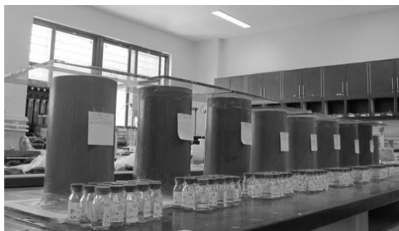
شکل ۴- قالب‌های انتشار مولکولی به همراه نمونه‌های محلول کلرور سدیم منبع در آزمایش‌های انتشار مولکولی ترکیبات ماسه- بنتونیت
