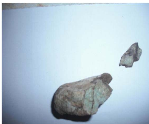
شکل ۲۷- دانه ترک خورده جدا شده در مصالح NA ۱۰۰٪
