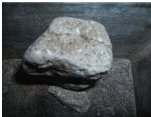
شکل ۲۵- دانه ترک خورده در مصالح NA ۱۰۰٪
