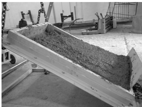
شکل ۵- بتن بر روی شیب ۳۰ درجه شریخته شده و باعث جداشدگی سنگ‌دانه‌ها شده است
