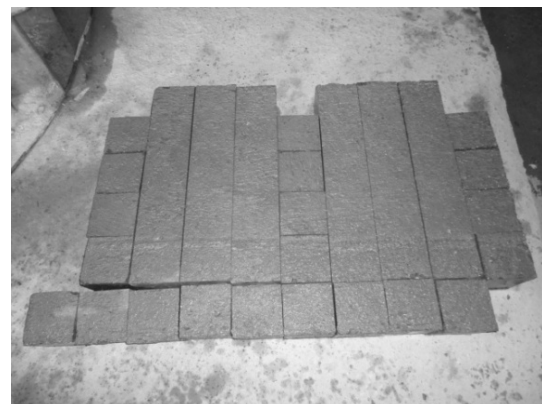
شکل ۷- تهیه نمونه ها از قسمت های مختلف پانل بتنی
