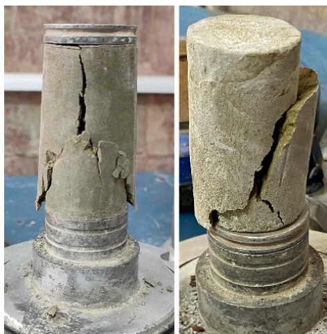
شکل 3- تصاویر نمونه‌های شکسته شده
