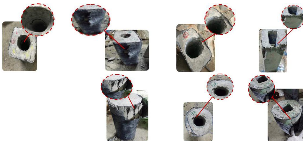
شکل ۳- نمایشی از نمونه‌های آزمایش شده پس از شکست و انواع مدهای شکست
