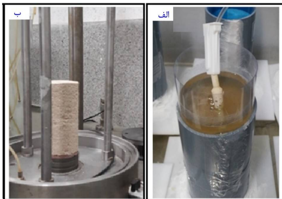
شکل 4 - الف) تزریق محلول سیمانانتاسیون ب) نمونه پس از بهسازی در دستگاه آزمایش سه محوری.
