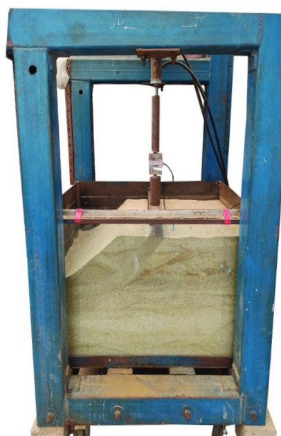
شکل 6- سیستم مدل فیزیکی هنگام بارگذاری در شیب ماسه‌ای
