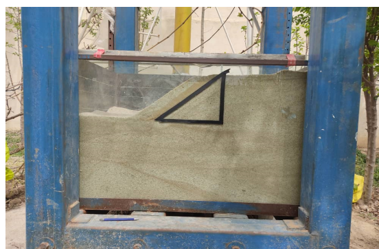
شکل 7- نتیجه توزیع جابه‌جایی عمودی آزمایش شماره 14 پایه نواری (نشست مجاز)
