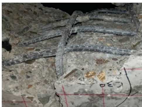
شکل 10- وضعیت میلگردهای طولی در پایان آزمایش در نمونه پایه یا نمونه شماره 1 (B1)
