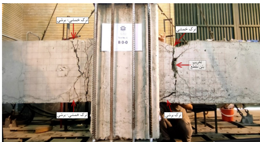
شکل 8- حالت نهایی نمونه مبنا یا B1 در حالت نهایی (اتمام آزمایش)
