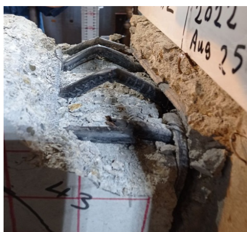
شکل 11- وضعیت میلگردهای طولی در پایان آزمایش در نمونه شماره 2 (B2)
