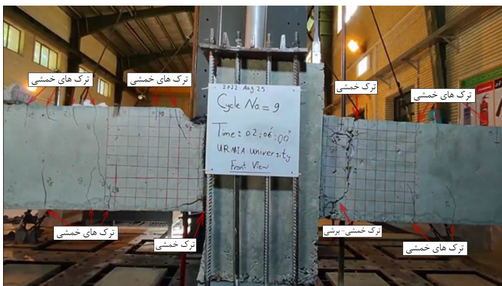
شکل 9- حالت نهایی نمونه دوم یا B2 در حالت نهایی (اتمام آزمایش)
