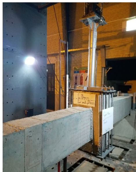
شکل 4- نمونه تیرستون بتنی قرار داده شده بر زیر جک هیدرولیکی قبل از شروع آزمایش
