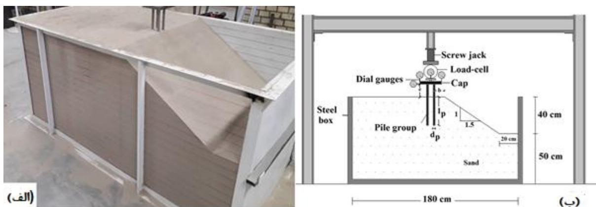
شکل ۲- جزئیات مدل فیزیکی استفاده شده در تحقیق الف) مدل فیزیکی اجرا شده ب) طرح شماتیک نحوه اجرای مدل فیزیکی
