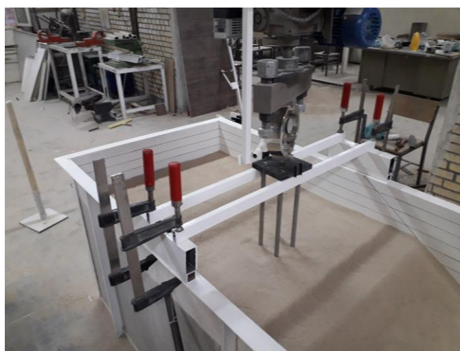
شکل ۳- نحوه استقرار گروه شمع هنگام اجرای شیروانی ماسه‌ای
