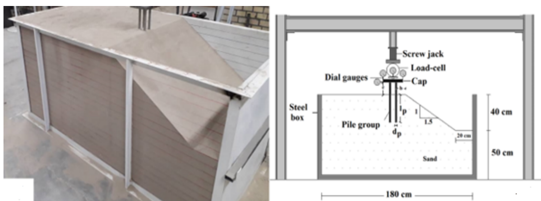
شکل 2- جزئیات مدل فیزیکی استفاده شده در تحقیق
