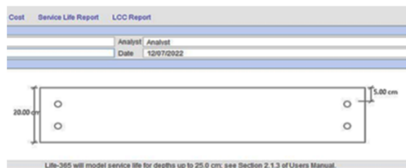
شکل 2- ابعاد نمونه دال بتن آرمه آزمایشی
