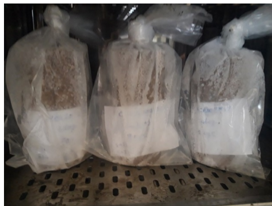
شکل 4- نمونه‌های ساخته شده بعد از فرآیند یخ‌زدن در یخچال
