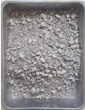
شکل 2- دانه‌های بتن بازیافتی استفاده شده در تحقیق حاضر
