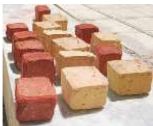
شکل ۲- نمونه های ۵ سانتی متری اندود برای انجام آزمایش تعیین ضریب هدایت حرارتی
