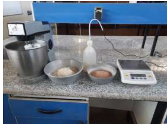
شکل ۴- روش آماده‌سازی نمونه‌های خاک مخلوط همگن
