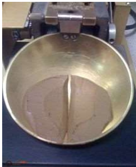
شکل ۵- ایجاد شیار بر روی نمونه خاک در دستگاه کاساگرانده
