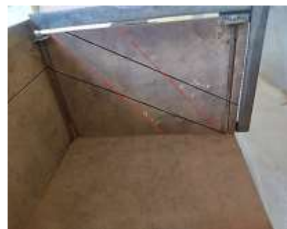
شکل ۶- نحوه لایه‌بندی مخلوط جهت تراکم نمونه در زوایای مختلف در قالب نمونه‌سازی
