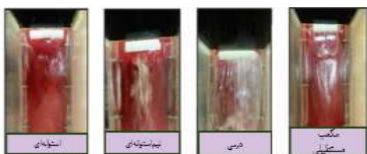
شکل ۹- قرارگیری آستانه در حالت مماس بر پایین دست دریچه کشویی: الف) مکعب مستطیلی، ب) هرمی، ج) استوانه ای، د) نیم استوانه ای
