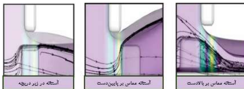
شکل ۴- تصویر شماتیک جریان عبوری از دریاچه کشویی در موقعیت‌های مختلف قرارگیری آستانه: الف) زیر دریاچه، ب) مماس بر پایین‌دست دریاچه، ج) مماس بر بالادست دریاچه
