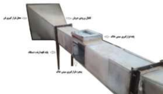
شکل ۲- دستگاه تونل باد ساخته‌شده جهت آزمایش فرسایش بادی نمونه‌ها
