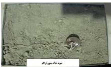
شکل ۱۳- آزمایش نفوذ مخروط
