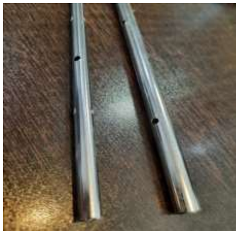
شکل ۶- ریزشمع‌های جدار نازک با سوراخ‌هایی در جداره برای نفوذ راحت‌تر دوغاب تزریقی به پیرامون ریزشمع
