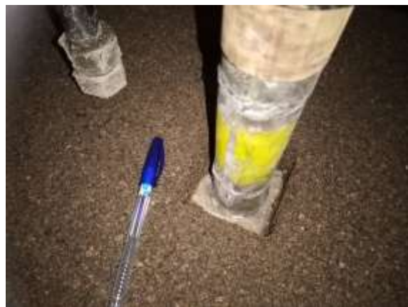
شکل ۱۳- گسیختگی در خاک مسلح شده در آزمایش تزریق زیستی N=3 , L=20 و D=0.8
