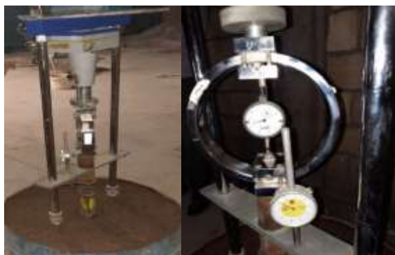
شکل ۵- مجموعه ست بارگذاری صفحه، رینگ نیروسنج و گنج تغییر مکان سنج
