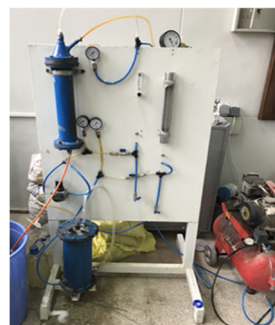
شکل 3- الف) فوم مصرفی KF168B و UGC-N2، ب) میکسر مورد استفاده و شمای کلی دستگاه فوم‌ساز
