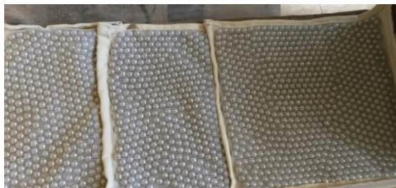
شکل ۶- گوی‌های فولادی با قطر ۱۲ و ۲۰ میلی‌متر استفاده‌شده به‌عنوان سربار یکنواخت روی خاکریز
