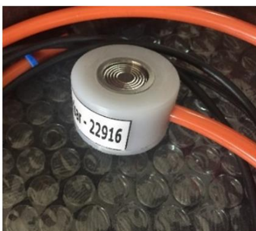
شکل ۴- فشارسنج‌های مینیاتوری نصب شده در دیوار صلب ضخیم
