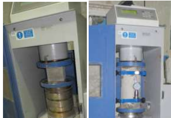
شکل ۳- الف) نمونه آزمایش فشاری، ب) نمونه آزمایش مدول الاستیسیته زیر جک فشاری هیدرولیکی
