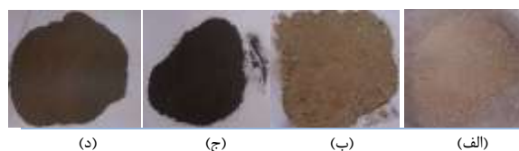
شکل ۱- الف) خاک مارن (Marl)، ب) خاک لایروبی (PGD)، ج) ریزدانه سرباره BOF، د) ریزدانه سرباره EAF
