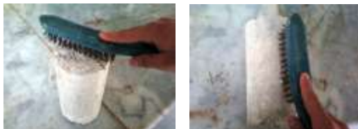
شکل ۳- برس زدن نمونه‌ها در آزمایش دوام- تر و خشک شدن
