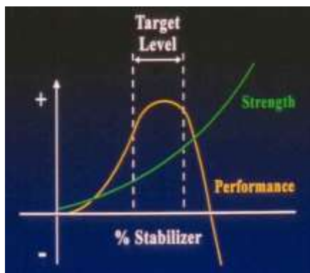
شکل ۴- رابطه بین مقدار سیمان، مقاومت فشاری و عملکرد مخلوط تثبیت‌شده (Tang و Labuz، ۲۰۱۲)
