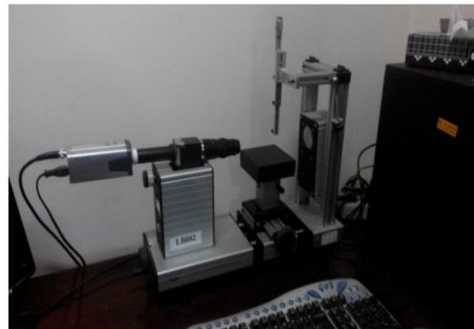
شکل ۳- تجهیزات آزمایش قطره چسبان
