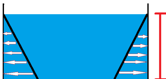
شکل ۶- توزیع قائم فشار هیدرواستاتیکی در مخزن آب
