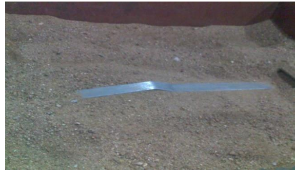
شکل ۱۳- تغییر شکل پلاستیک تسه فلزی نمونه ۱۶
