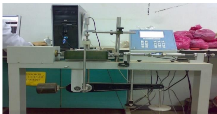
شکل ۸- دستگاه برش مستقیم مورد استفاده در این تحقیق
