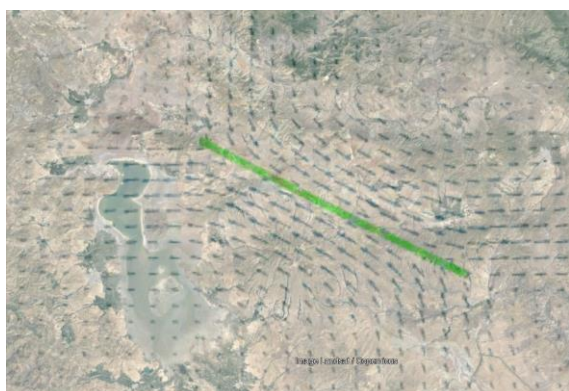
شکل ۱۳- جانمایی بردارهای جابه‌جایی‌های سطحی ناشی از فعالیت بین‌لرزه‌ای گسل شمال تبریز در عکس ماهواره‌ای که در اطراف گسل بیشینه است
