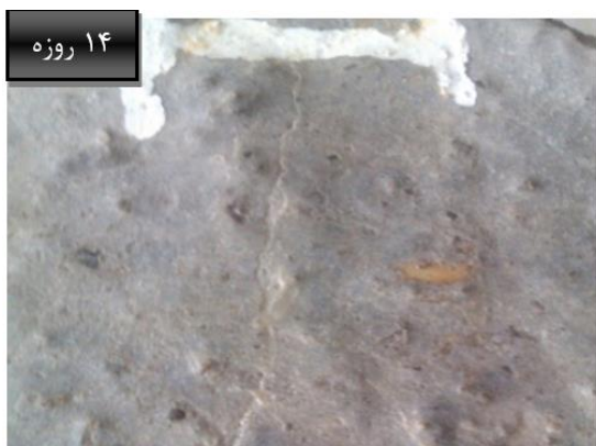
شکل ۱۵- تصویر میکروسکوپی از عامل خودترمیمی
