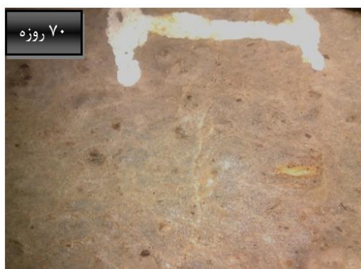
شکل ۱۶- روند ترمیم ترک در مخلوط M4 در سنین مختلف
