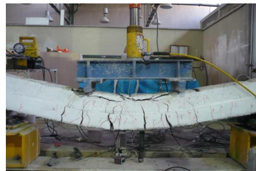
شکل ۷- الگوی انهدام تیر RCH II
