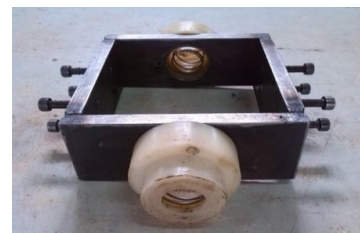
شکل ۱- غلاف نگهداری سنسورهای دستگاه اولتراسونیک
