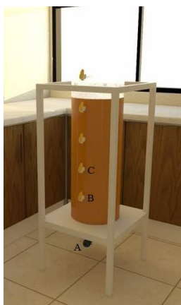
شکل ۱- تصویر شماتیک راکتور مورد استفاده در تحقیق: A شیر تخلیه برای شستشوی راکتور، B شیر تخلیه لجن معلق مازاد، C شیر نمونه‌گیری
