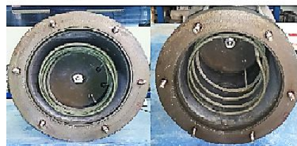
شکل ۱- دستگاه سه‌محوری اصلاح شده: الف) نمای کلی دستگاه، ب) تابلوی برق دستگاه، ج) المنت حلقه‌ای و دماسنج
