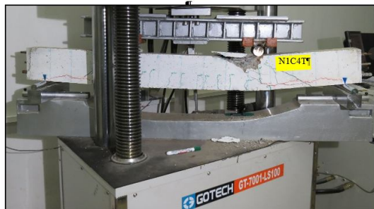
شکل ۷- آزمایش شکست با روش خمش چهار نقطه‌ای
