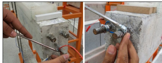
شکل ۵- نحوه اتصال جریان الکتریکی به نمونه‌ها
