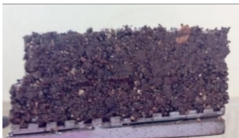
شکل ۲- نمونه آلوده شده نفتی پس از آزمایش در دستگاه برش مستقیم
